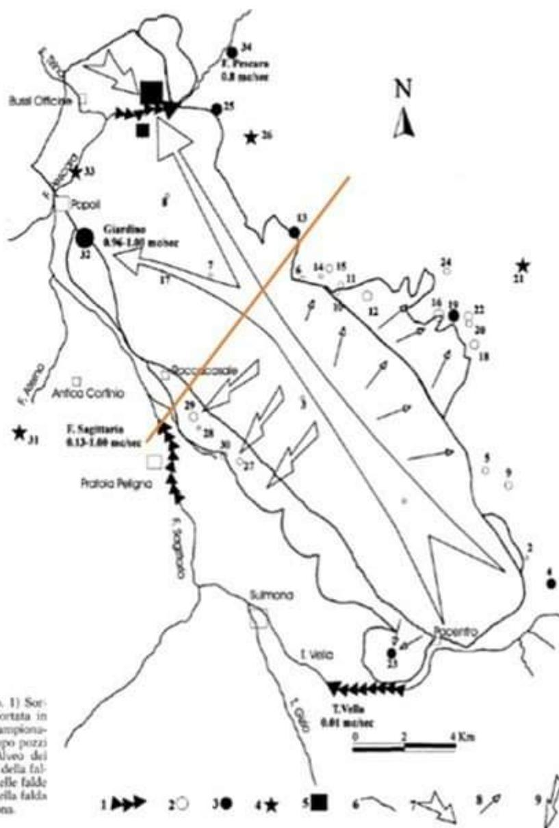
Fig. 14 - Schema idrogeologico. 1) Sorgenti lineari e incrementi di portata in alveo; 2) Sorgenti; 3) Sorgenti campionate; 4) Sorgenti sulfuree; 5) Campo pozzi acquedotto del Giardino; 6) Alveo dei corsi d'acqua; 7) Linee di flusso della falda di base; 8) Linee di flusso delle falde minori; 9) Linee di drenaggio della falda di base verso la Piana di Sulmona.
